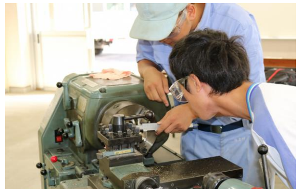
旋盤で黄銅六角棒を削る(文鎮の製作)
